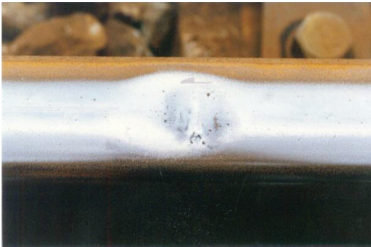
Rys. 2. Przykład wady powierzchniowej typu squat
