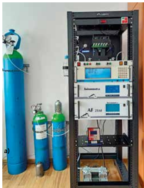
Rys. 3. Stanowisko badawcze do badania zdolności do fotokatalitycznego rozkładu zanieczyszczeń powietrza. a) widok ogólny, b) próbka zaprawy w czasie badania
