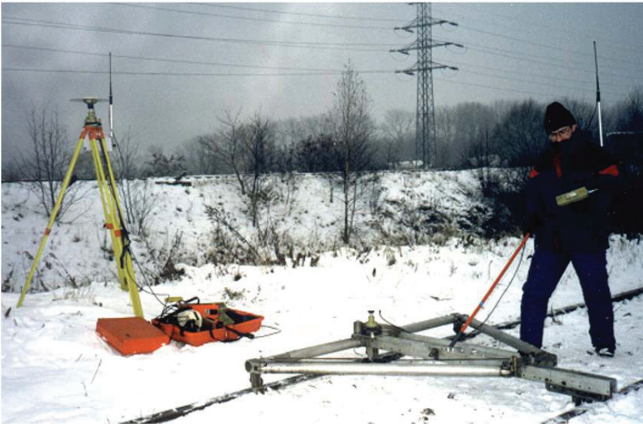
Rys. 1. Pierwszy odbiornik satelitarny RTK GPS na polskich torach
