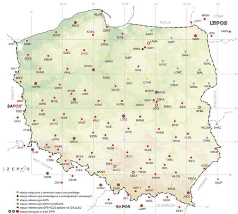
Rys. 2 Lokalizacja stacji referencyjnych systemu ASG-EUPOS {18}
