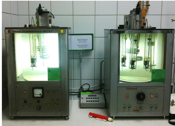
Rys. 1. Stanowisko do oznaczania lepkości kinematycznej w Zakładzie Oceny Właściwości Eksploatacyjnych Instytutu Nafty i Gazu w Krakowie
