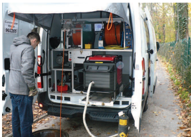
Rys. 1. Mobilne urządzenie diagnostyczne CCTV oraz do badania szczelności przewodów będące na wyposażeniu laboratorium Politechniki Świętokrzyskiej (zdjęcie własne)
