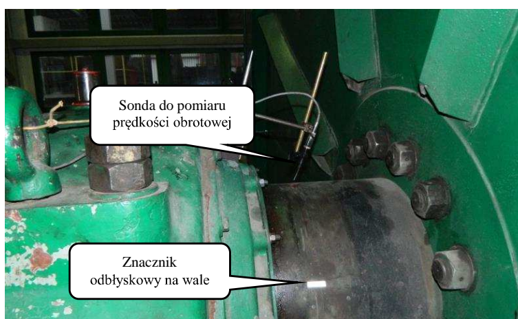
Rys. 4. Umieszczenie sondy przetwornika do pomiaru prędkości linopędni – pomiar weryfikacyjny [5]
