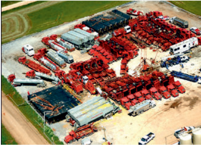
Rys.9. Otoczenie głowicy wydobywczej podczas zabiegu szczelinowania [15]
