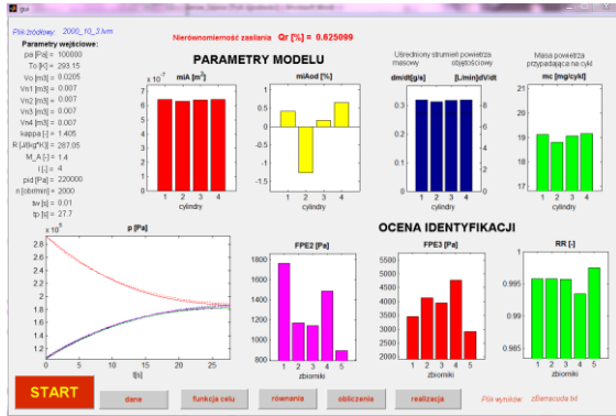
Rys. 6. Panel komunikacyjny programu do identyfikacji istotnych parametrów przyjętego modelu przepływu i dodatkowych wyliczonych wartości
