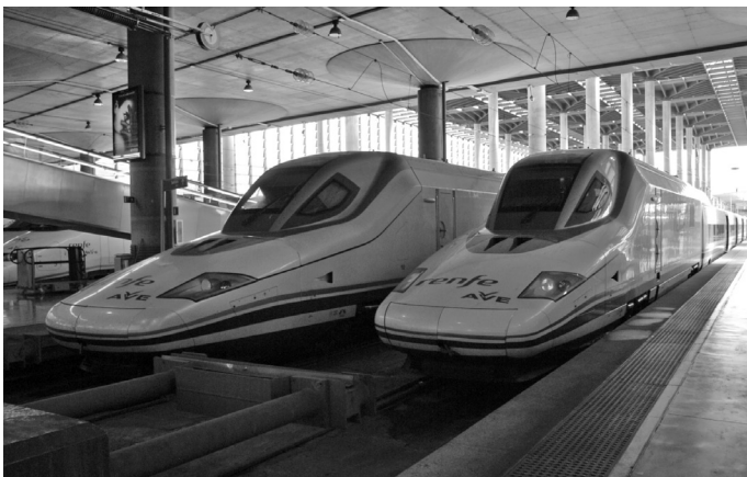
Fot. 1. Składki zespolone S102 i S112 na stacji Madrid Puerta de Atocha (Fot. Radosław Bul, 2012)
