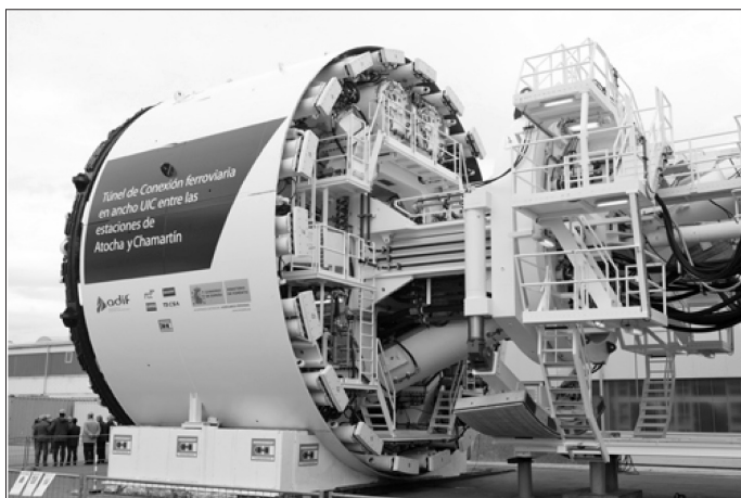
Rys. 5. Maszyna TBM wykorzystana podczas drążenia tunelu AVE (III) Atocha–Chamartín Źródło: ADIF – Administrador de Infraestructuras Ferroviarias, 2012
