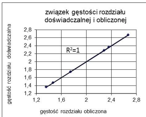
Rys. 19. Związek obliczonej i doświadczalnej gęstości rozdziału Fig. 19. Relationship of calculated and experimental separation density
