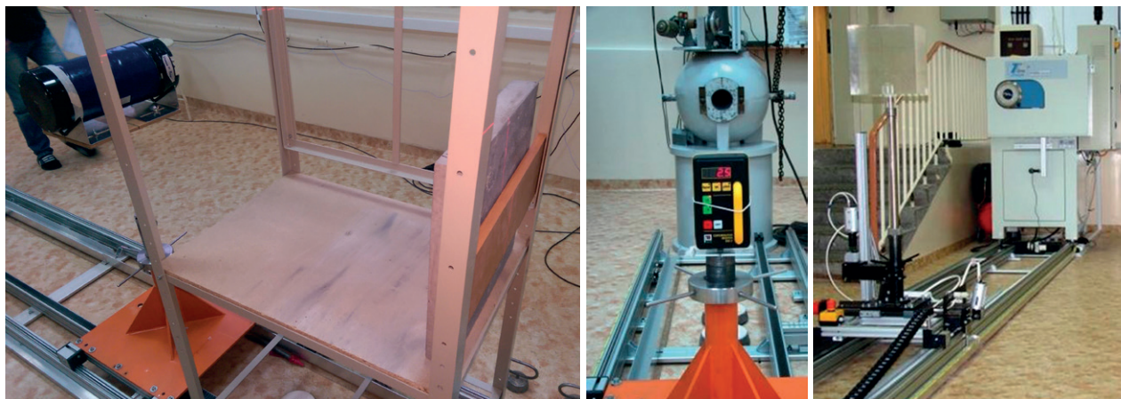
Rys. 1. Stanowisko pomiarowe w hali kalibracyjnej Laboratorium Pomiarów Dozymetrycznych w Departamencie Energetyki Jądrowej Narodowego Centrum Badań Jądrowych (LPD DEJ NCBJ)
