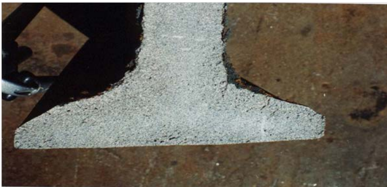
Rys. 4. Matowe punkty na pękniętej powierzchni styku spawanego
