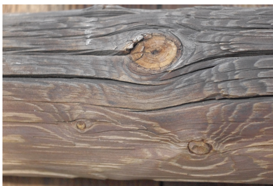
Rys. 3. Drewno sosnowe wystawione na działanie warunków atmosferycznych przez około 80 lat (fot. B. Ordon-Beska)
