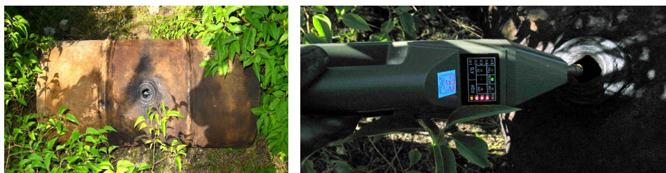
Rys. 1. Widok beczki i wskazania przyrządu AP-2C przy korku beczki na torze „H”
