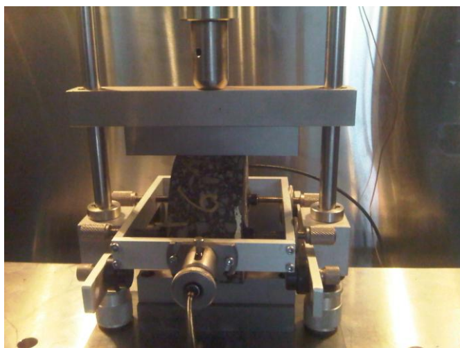
Rys. 1. Aparatura do badania modułu sztywności metodą IT-CY.
