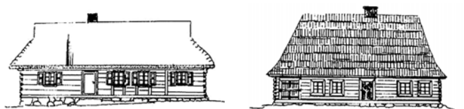
Ryc. 1. Karczma z Sochocina (XVIII w.) z konstrukcją ścian sumikowo-łątkową i chałupa z Rebowo (1875 r.) z konstrukcją zrębową ścian
