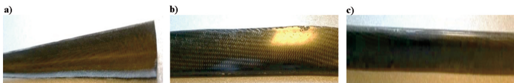
Rys. 5. Krawędź natarcia łopaty nośnej wykonana w technologii ręcznego laminowania „na mokro” z zastosowaniem worka próżniowego: a) widok od wewnątrz, b) widok z góry, c) widok od frontu [Autor, 2015]
