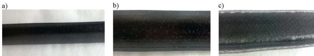
Rys. 18. Krawędź natarcia łopaty nośnej wykonana w technologii preimpregnatowej: a) widok z góry, b) widok z boku, c) widok od wewnątrz [Autor, 2015]
