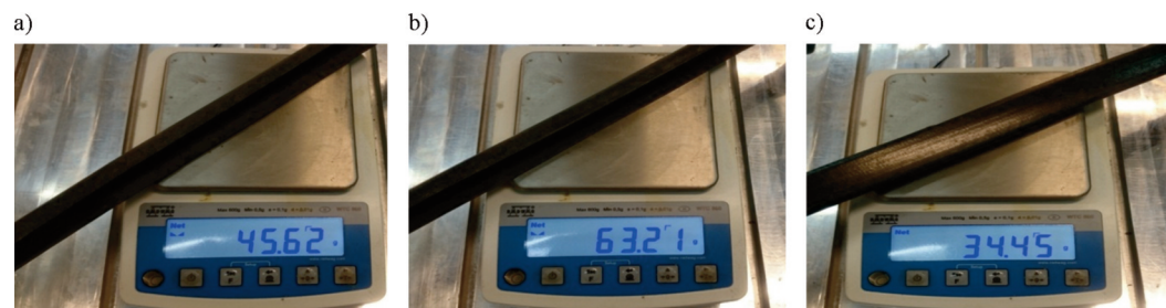
Rys. 20. Ważenie odcinków noska wykonanych w technologii: a) na mokro (vacuum), b) infuzji, c) preimpregnatowej. [Autor, 2016].
