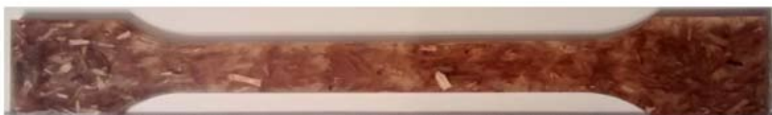
Rys. 3. Wypraska z polilaktydu z napełniaczem w postaci wiórów
