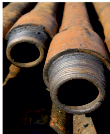
Fot. 2. Rurociągi z widoczną korozją równomierną Photo 2. Pipelines with visible uniform corrosion
