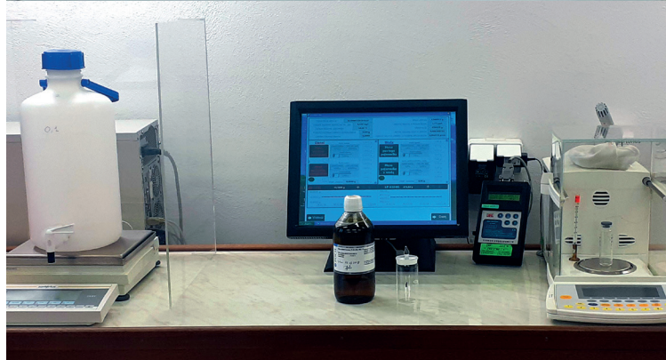
Rys. 2. Stanowisko do grawimetrycznego wytwarzania RM i widok naczynia do ważenia etanolu
