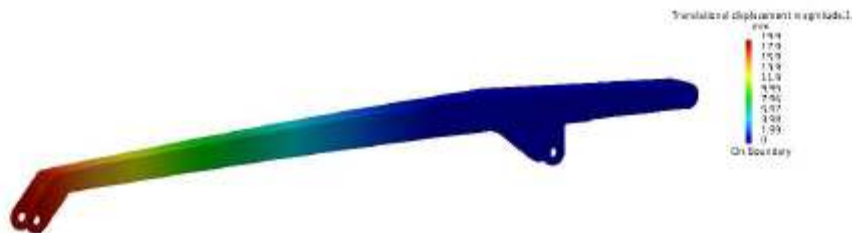
Rys.14. Wysięgnik krótki – rozkład naprężeń Źródło: badania własne autora
