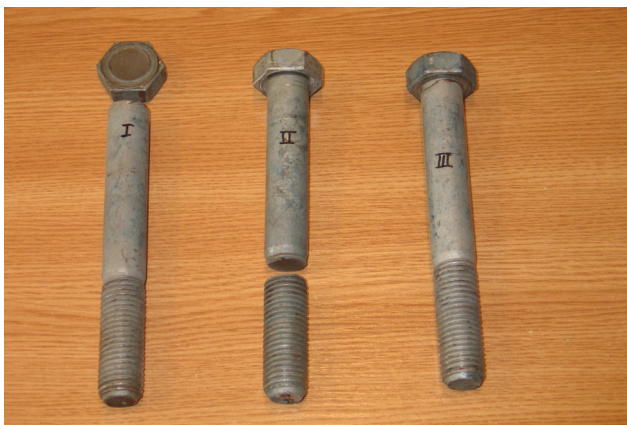
Rys. 1. Pęknięte śruby M24: nr „I” i „III” w obszarze łba śruby, nr „II” od początku gwintu [1].
