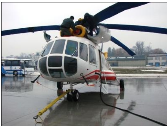
Fot. 1. Widok wielozadaniowego śmigłowca wojskowego typu Mi-8 z systemami pokładowymi w czasie badań instalacji przeciwpożarowej SSP-FK [materiał ITWL, 2014]
