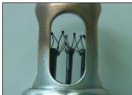
Fot. 3. Widok elementów termoelektrycznego dla czujnika pożaru typu DTBG [materiał ITWL, 2015]
