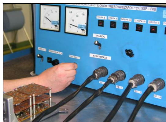
Fot. 6. Widok specjalizowanego stanowiska kontrolnego do badań progów zadziałania instalacji przeciwpożarowej SSP-FK w zależności od napięcia zasilania [materiał ITWL/WZL, 2015]
