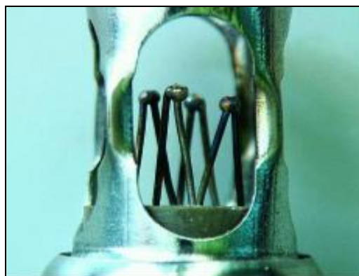
Fot. 2. Widok elementów termoelektrycznego dla czujnika pożaru typu DPS [materiał ITWL, 2015]
