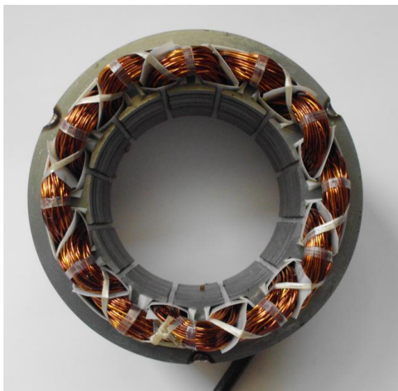
Rys. 3. Stożak generatora z cewkami skupionymi
