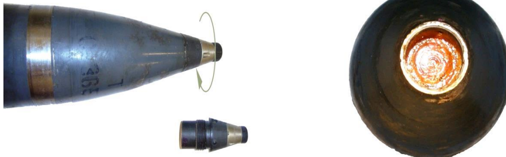
Fot. 2. Widok materiału wybuchowego w skorupie pocisku artyleryjskiego po wykręceniu zapalnika
