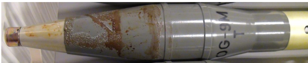
Fot. 3. Głowica 73 mm naboju granatnikowym OG-9M ze śladami oleju trotylowego Photo 3. Head of 73 mm grenade launcher round OG-9M with traces of trotyl oil
