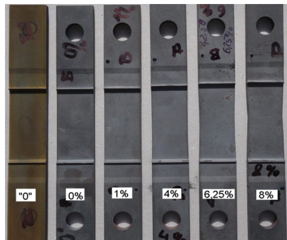
Rys. 4. Fotografie próbki „0” i próbek po pełzaniu do zadanego wydłużenia
