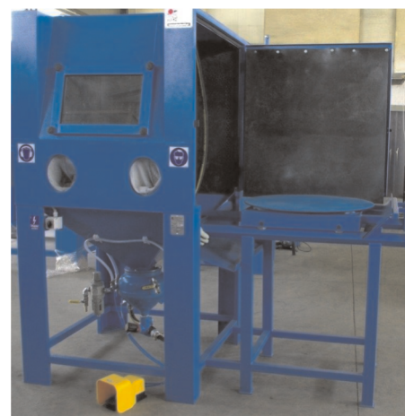
Rys. 1. Oczyszczarka kabinowa KCW-100 o komorze roboczej 2000 × 1500 mm z wysuwającym stołem roboczym do obróbki ciężkich przedmiotów [2]
