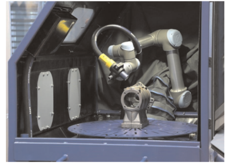
Rys. 8. Zrobotyzowane stanowisko obróbki strumieniowo-ścierniej w ciśnieniowej oczyszczarce kabinowej firmy Sant-Tech [1]
