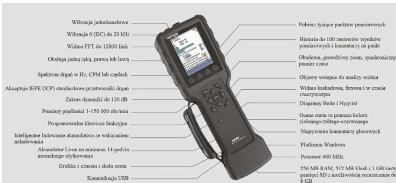
Rys. 1. Widok urządzenia Leonova Emerald i jego elementy funkcyjne [3]
