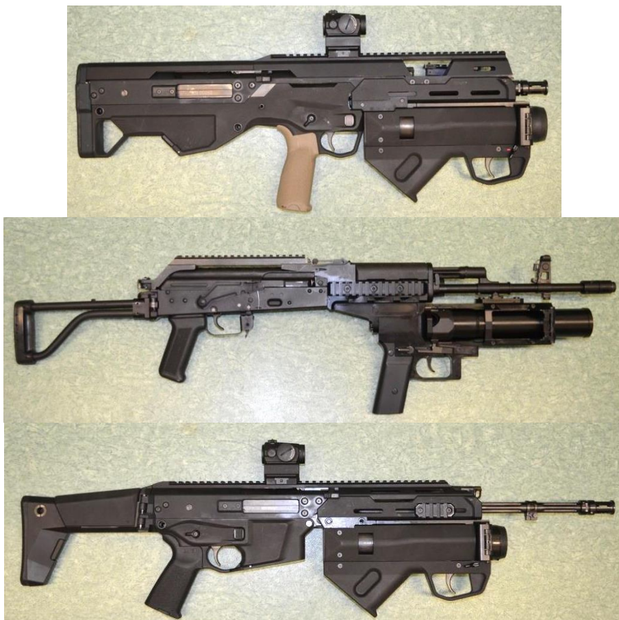
Fot. 1.1. Karabinki-granatniki użyte do badań, od góry: MSBS-5,56K, MSBS-5,56B i wz. 96 „Beryl” z GPBO-40
