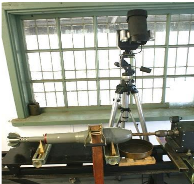
Fot. 3. Ogólny widok stanowiska do prac szczególnie niebezpiecznych. Pobieranie materiału wysokoenergetycznego do badań laboratoryjnych
