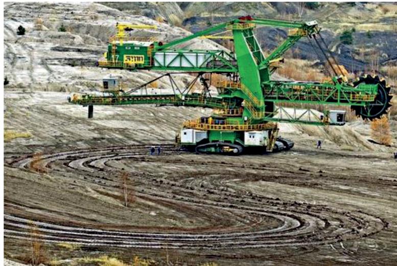
Rys. 6. Koparka KWK-910 w trakcie zjazdu z placu montażowego na poziom roboczy - widać wyraźne ślady jazdy po łukach o małym promieniu (25 m) [16]
