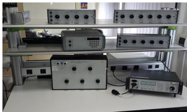
Rys. 2. Stanowisko do wzorcowania mierników parametrów instalacji elektrycznych
