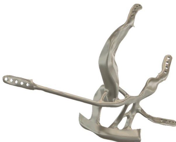
Rys. 5. Geometria implantu kości jarzmowej uzyskana z wykorzystaniem projektowania generatywnego dla obciążenia 250 N
