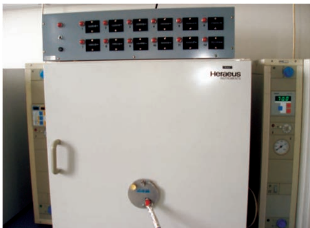
Rysunek 1 Suszarka do pomiaru kohezji z widocznymi u góry zegarami pomiarowymi
