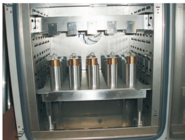
Rysunek 6 Wkład do badania kohezji z ciężarkami o masie 10 N oraz umieszczonymi u góry płytkami stalowymi
