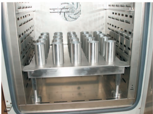
Rysunek 5 Wnętrze suszarki z umocowanym wkładem do badania kohezji
