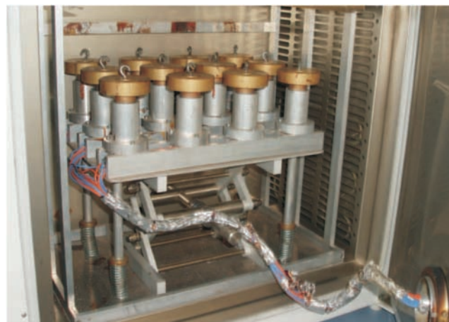
Rysunek 2 Wnętrze suszarki adaptowanej do pomiaru kohezji z widocznym na zdjęciu kablem
