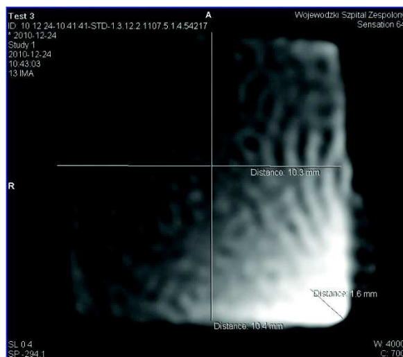
Rys. 7. Tomogram warstwy przechodzącej przez wierzchołki nierówności. Próbka 3b, obraz warstwy przekroju o grubości 0,2 mm, powiększenie ok. 100x, algorytm skanujący B20s Fig. 7. A tomogram of the layer through picks in the surface roughness. Sample 3b, image layer of thickness 0.2 mm, zoom ca 100x, scanning algorithm B20s
