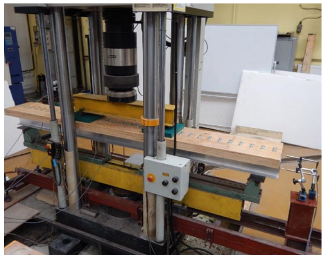
Rys. 6. Belka zespolona aluminiowo-drewniana ze śrubami podczas badań [5]
