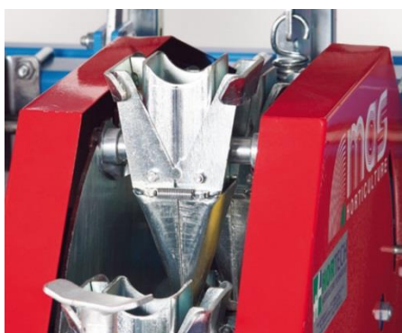
Рисунок 2. Высаживающий аппарат в виде конуса машины Over Figure 2. Planting unit in the form of the Over machine cone
