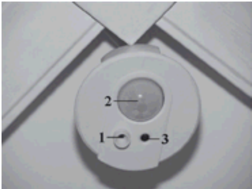
Rys. 2. Widok multiczuJNIka składającego się z czujników: 1 – zmian natężenia oświetlenia; 2 – ruchu; 3 – podczerwieni
