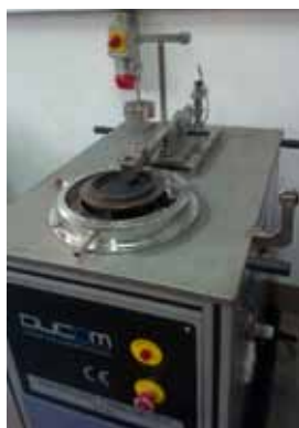
Rys. 8. Trybometr Ducom TR-20 do badań odporności na zużycie metodą pin-on-disc Fig. 8. Ducom TR-20 pin-on-disc tribometer for wear tests
