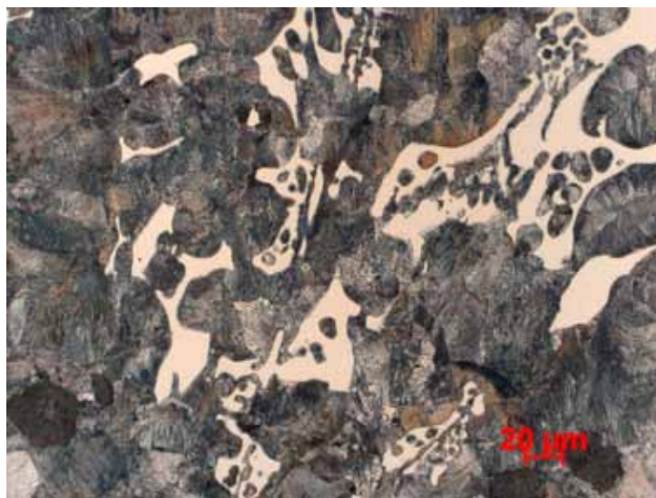
Rys. 4. Mikrostruktura żeliwa w stanie surowym Fig. 4. As-cast microstructure of cast iron
