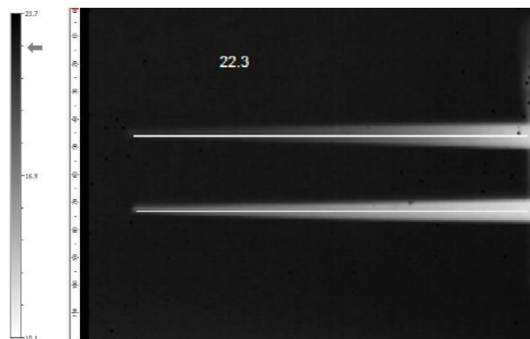
Rysunek 36: Termogram prętów stożkowych od góry: stalowego oraz aluminiowego.
