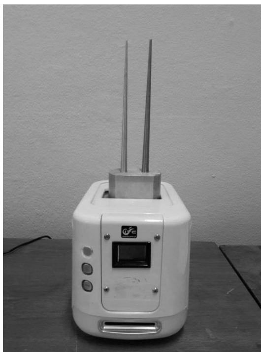
Rysunek 34: Stanowisko laboratoryjne do badania jednowymiarowego przewodzenia ciepła w prętach.
