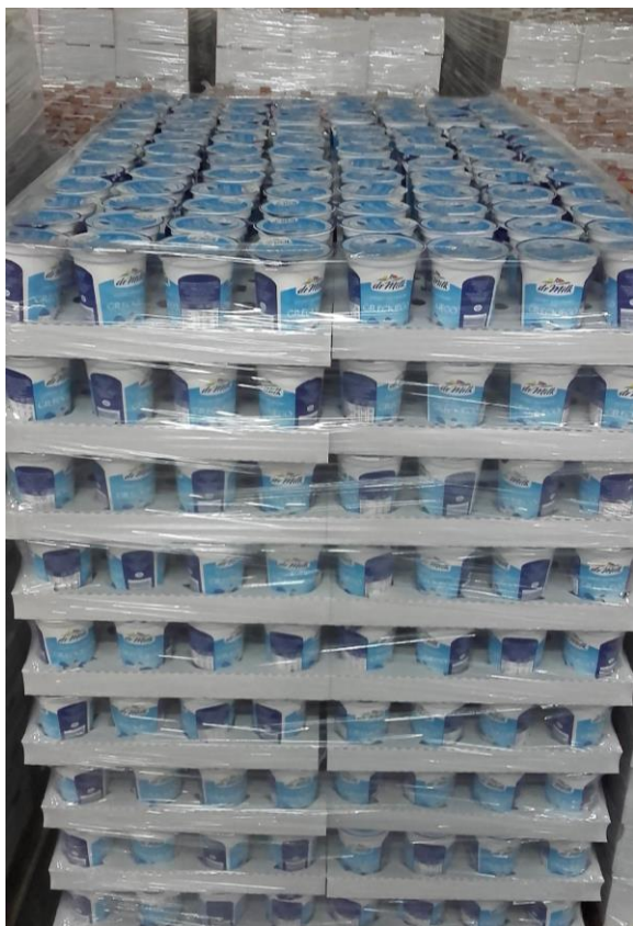
Rys. 5. Opakowanie zbiorcze tekturowe z pokryciem białym, w którym umieszczone są opakowania jednostkowe wykonane z PS
