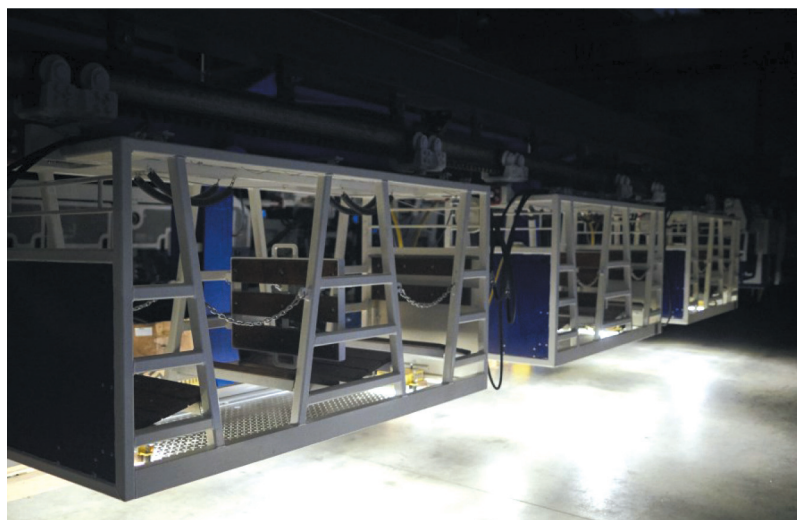
Rys. 4. Mobilne oświetlenie stacji osobowych z akumulatorowego ciągnika podwieszonego typu CA-190 (białe światło – ciągnik znajduje się na stacji osobowej)
