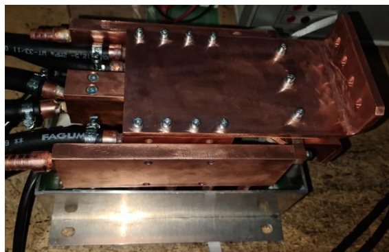
Rys.11. Jednofazowy transformator mocy typu 1TTFW-95 550//15V 10kHz 6kA S3 WF=4l/min z wymuszonym bezpośrednim chłodzeniem wodnym
