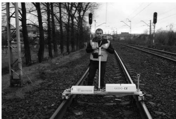
Rys. 3. Wózek pomiarowy GEDO CE z pryzmatem dalmierczym
