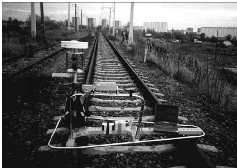
Rys. 1. Wózek pomiarowy z przyzmatem dalmierczym i anteną GPS
