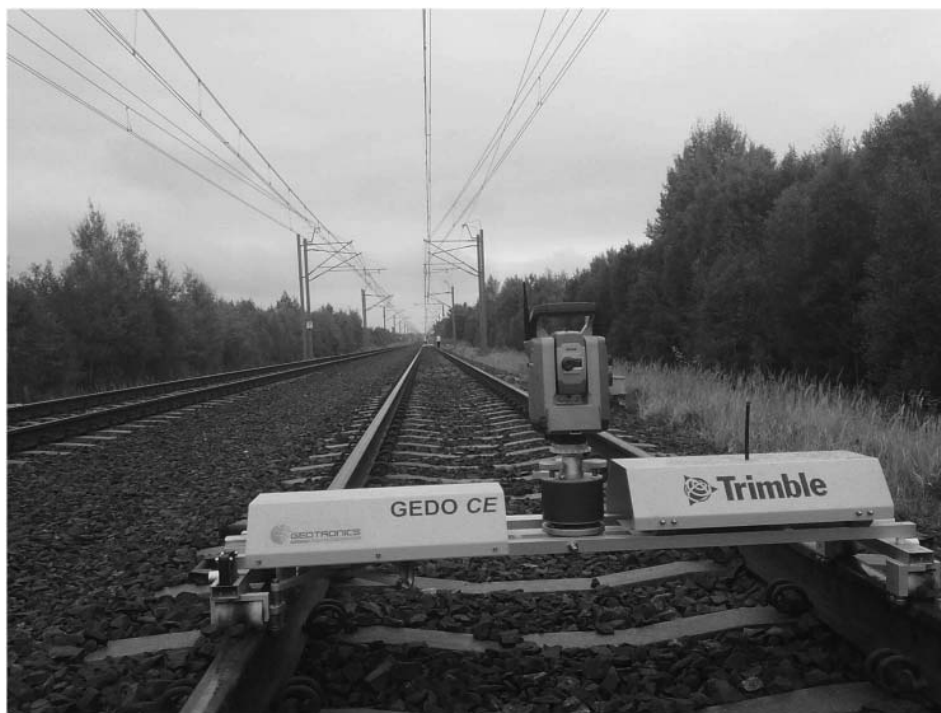
Rys. 4. Wózek pomiarowy GEDO CE z tachimetrem S-8
