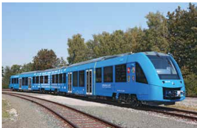
Zespół trakcyjny Coradia iLint wyposażony w układ paliwowy zasilany wodorem. fot. © Alstom
