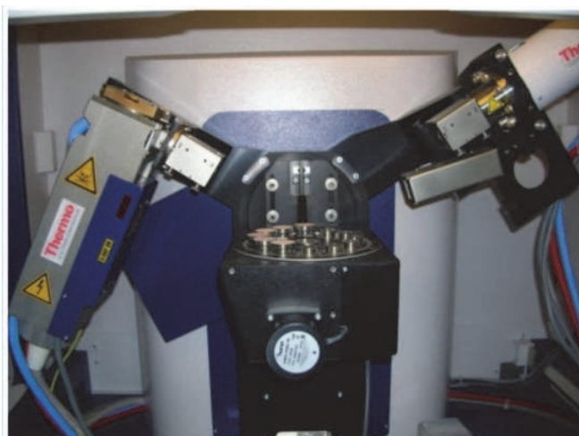
Rys. 2. Szwajcarski rentgenograf Thermo Electron, model ARL X'tra w laboratorium rentgenografii strukturalnej (XRD) Instytutu Geologii
