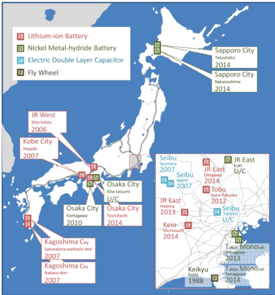
Rys. 1. Systemy magazynowania energii zainstalowane w sieciach trakcyjnych DC w Japonii [6]
