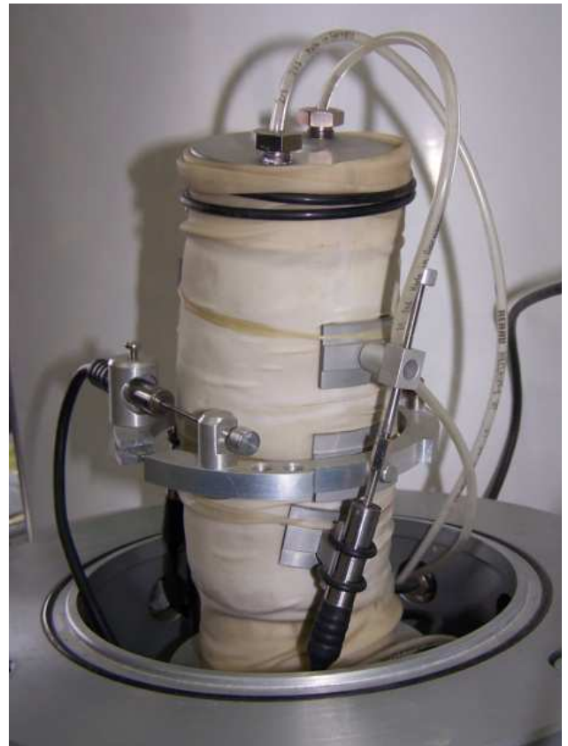
Rys. 4. Próba montażu czujników LVDT na próbce gliny pylastej w stanie plastycznym za pomocą taśm gumowych zgodnie z instrukcją producenta (Politechnika Śląska)
