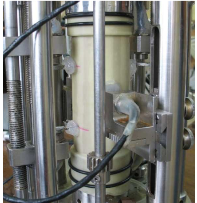
Rys. 7. Przykład montażu czujników zbliżeniowych (Politechnika Śląska)
