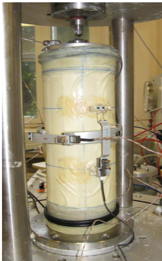
Rys. 5. Przykład montażu czujników wykorzystujących efekt Halla na próbce kaolinu Speswhite (Uniwersytet Bristolski)
