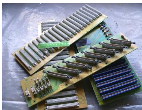
Rys.3.2 Płytki obwodów drukowanych użyte do prób-serwerowe
