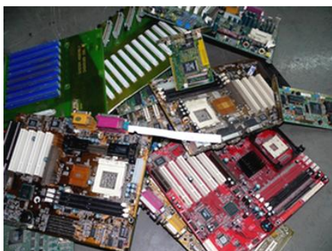
Rys.3.1 Tradycyjne płytki obwodów drukowanych użyta do prób rozdrabniania
