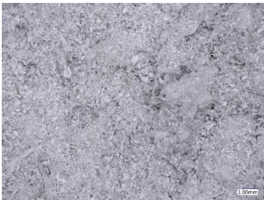
Rys. 1. Rozdrobnione strużyny garbarskie pod mikroskopem (KEYENCE VHX 950F), okular VH Z20R - powiększenie 20x [źródło: opracowanie własne].
