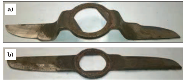
Rys. 12. Fotografie mieszadeł eksperymentalnych ze stali NANOS-BA ® po teście odporności na zużycie. a) mieszadło kształtowane, b) mieszadło płaskie
